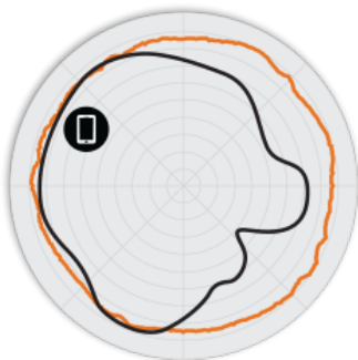
РИСУНОК 2 Азимутальная плоскость 2,4 ГГц R320 Диаграммы направленности антенны
