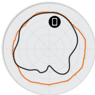
РИСУНОК 3 Азимутальная плоскость 5 ГГц R320 Диаграммы направленности антенны
